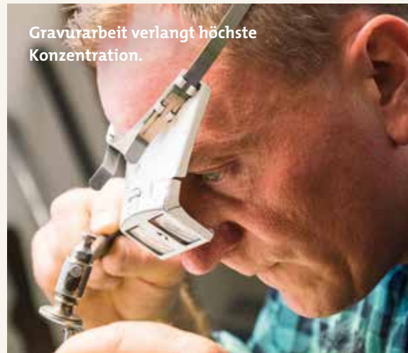
Ob der Stichel mit dem Hammer oder der bloßen Hand geführt wird, jede Bewegung muss absolut richtig sitzen.
